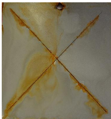
شکل ۸: تصویر نمونه پس از ۱۰۰ ساعت تست مه نمکی
